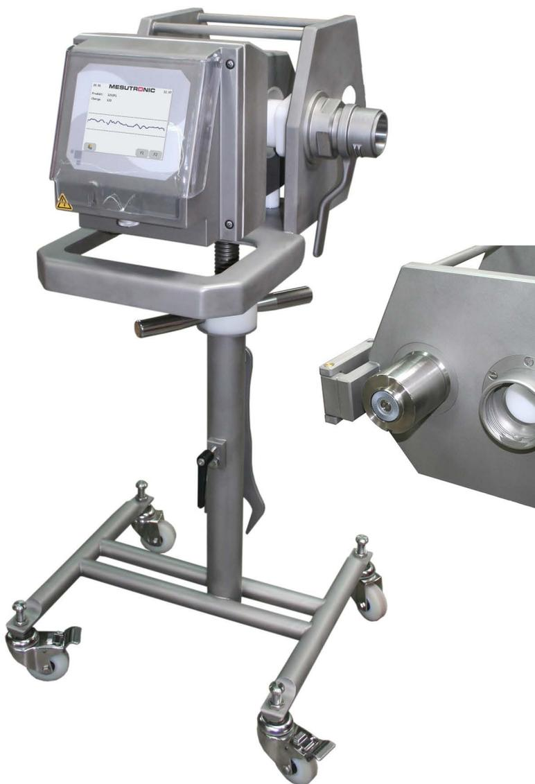
Détecteur de métaux avec rallonge de transmission de torsadeur pour raccordement sur des poussoirs de salaison
